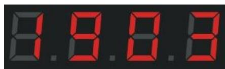
第三步：按
