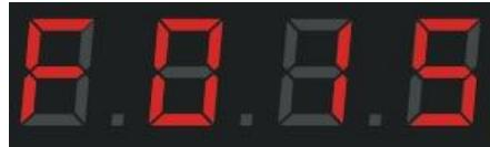
F: 控制器内置程序模式；01: 第一个程序；5: 速度 5
