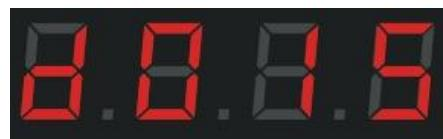
d: SD 卡的程序模式; 01: 第 1 个程序; 5: 速度 5
