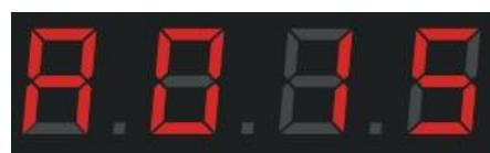
d: 代表 SD 卡程序单个循环; A: 代表 SD 卡程序全部循环。
